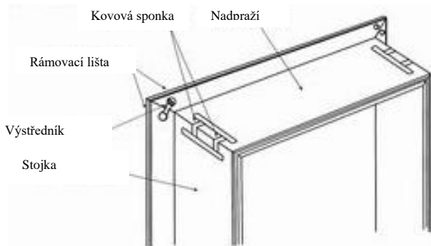
Obr.5: schéma montáže zárubně
